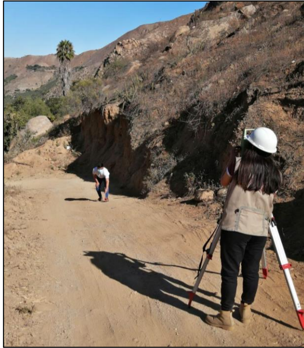
Imágen 9 Levantamiento topográfico del recorrido del sistema de abastecimiento de agua potable
