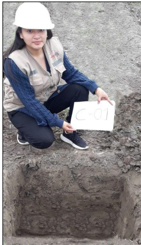
Imágen 10 Muestra de calicata para ensayo de mecánica de suelos
