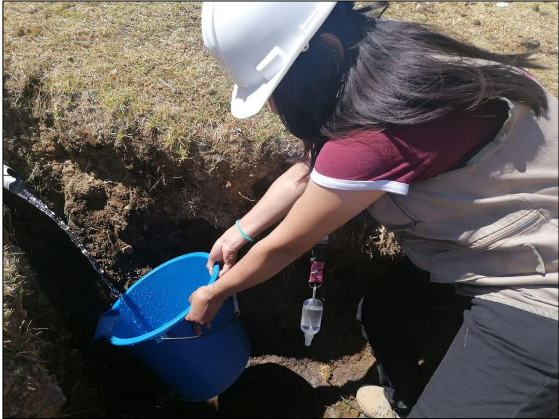
Imagen 11 Medición del caudal mediante el método volumétrico
