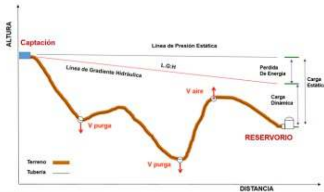
Ilustración N° 03.31. Línea de Conducción
