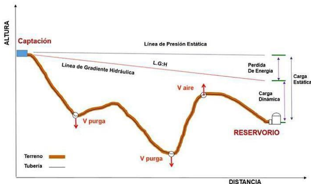
Ilustración N° 03.31. Línea de Conducción
