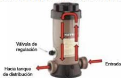
Ilustración N° 03.58. Dosificador por erosión de tableta
