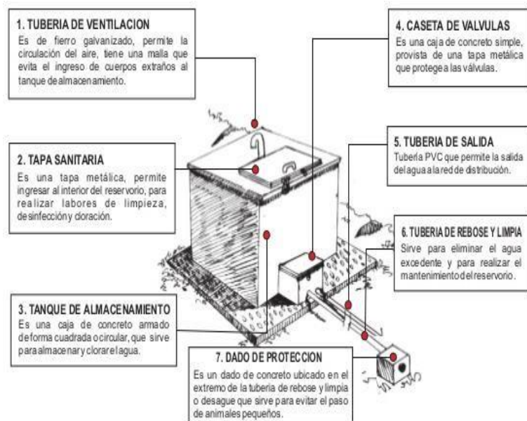
Imagen 8 : Partes de un reservorio de almacenamiento Fuente: Manual de captación JASS N°3
