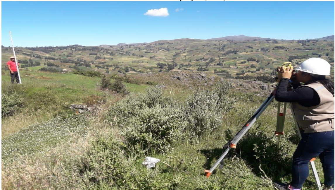
Figura 23. Estación total utilizada para el levantamiento topográfico. Fuente: elaboración propia (2018)
