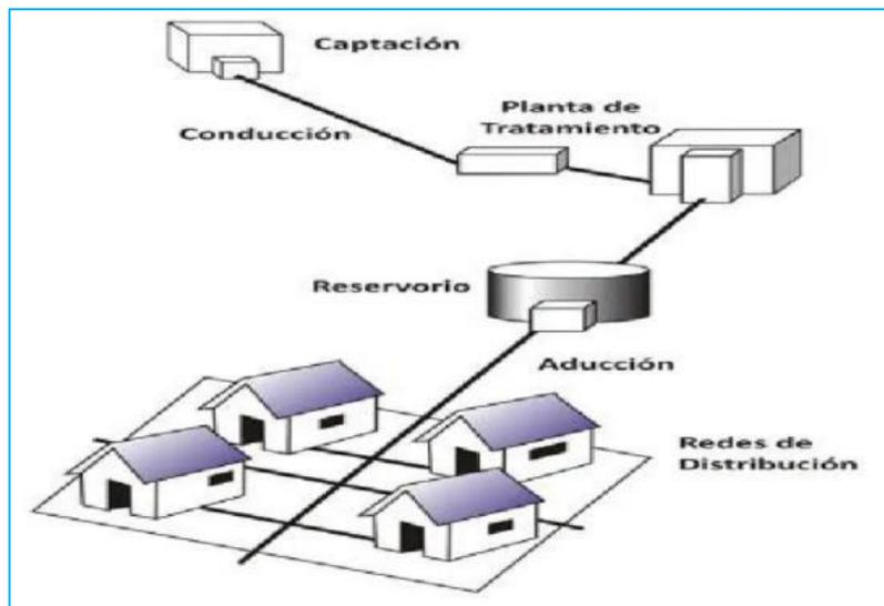
**Figura 6.** línea de conducción
