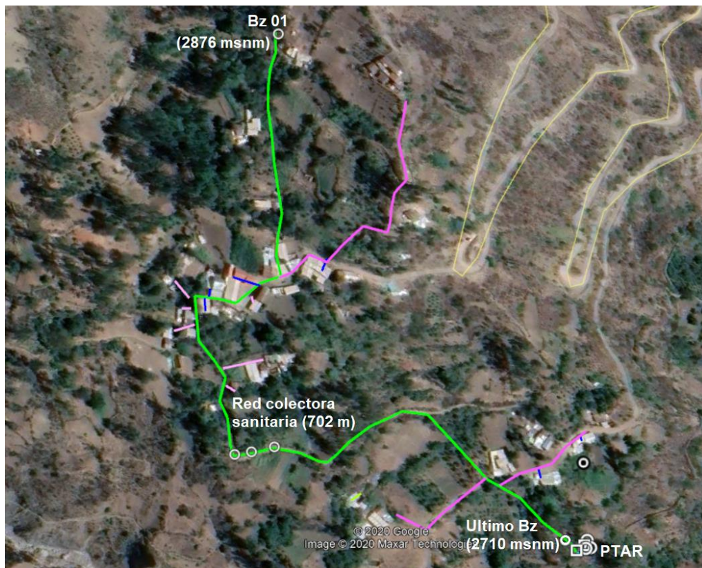
Imagen 12. Red colectora de aguas servidas, desde el primer buzón hasta el ultimo buzón
