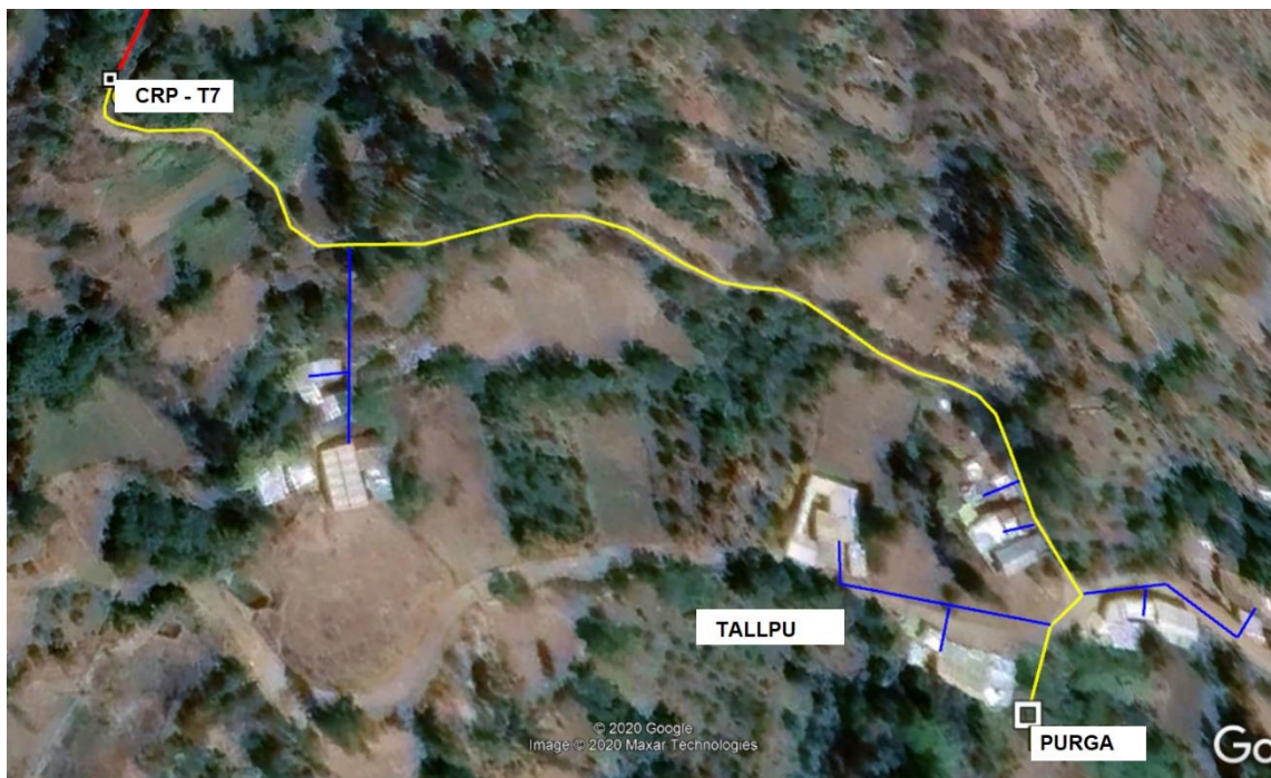
Imagen 09. Ramal abarca desde la CRP – T7 hasta la ultima vivienda del lugar denominado Tallpu
