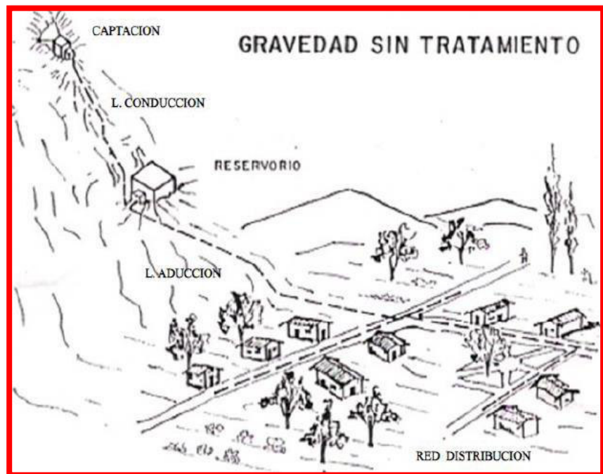
Figura 15. Línea de aducción
