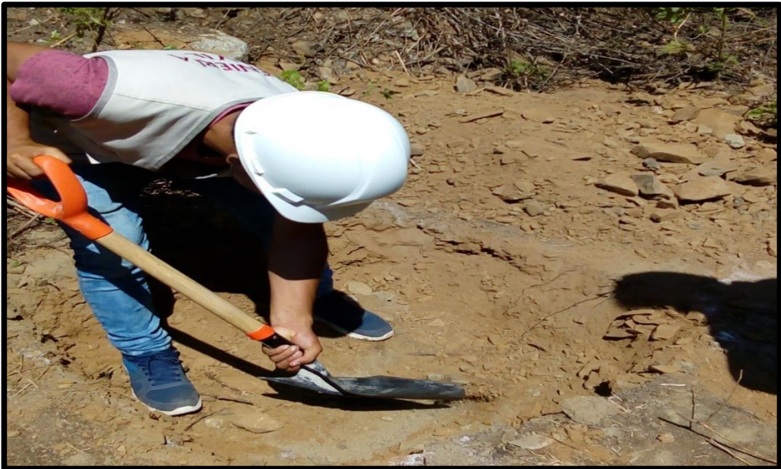
Figura 17: Excavación de la calicata 01
