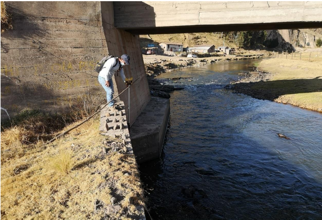
Vista fotográfica: Levantamiento de puntos en estribo de puente existente
