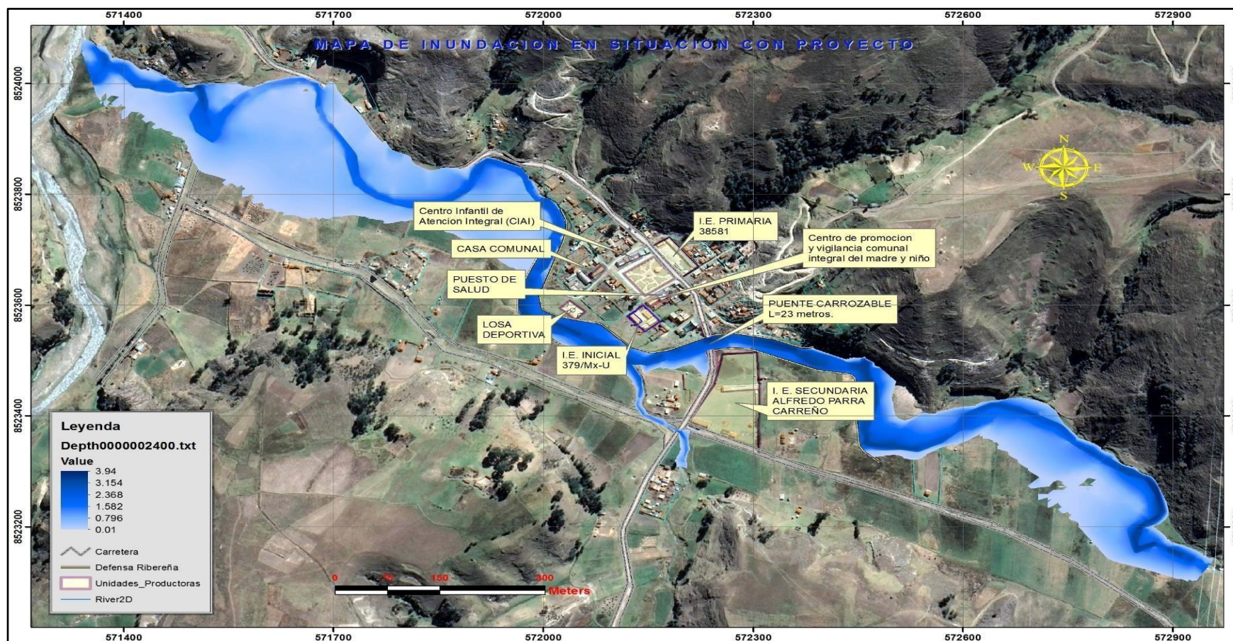
Gráfico 25. Control de inundación de avenidas máximas para un periodo de retorno de 100 años en situación con proyecto, en la imagen se distingue la protección de la defensa ribereña a los bienes del estado, instituciones públicas y viviendas privadas.
