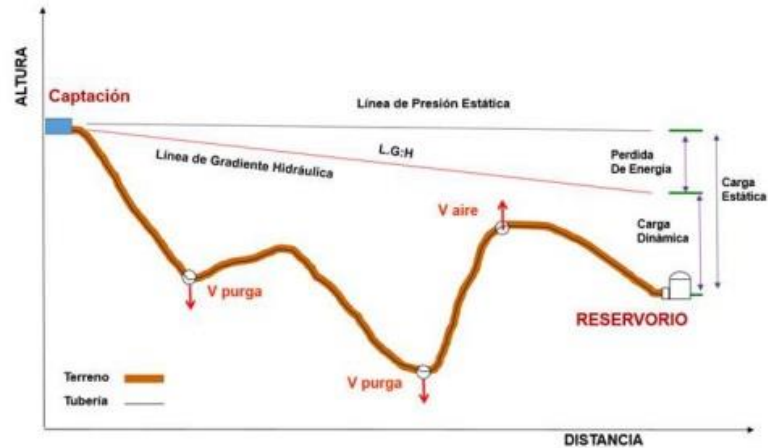
Ilustración N° 03.31. Línea de Conducción
