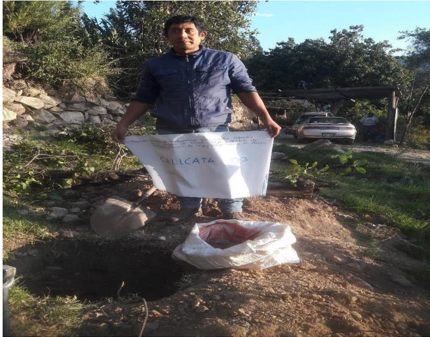
Fotografía 04: Se realizo la excavación para el test de percolación para poder determinar la infiltración del terreno.
