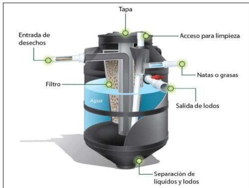
**Figura 1.** Esquema de Tanque Biodigestor
