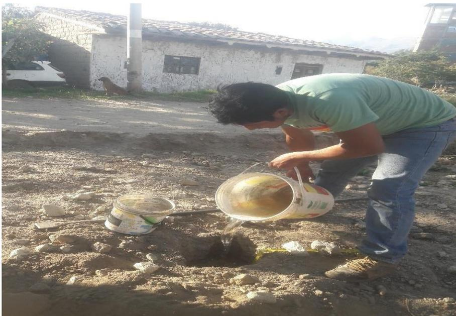
Fotografía 07: Se realizo el llenado de agua y la medición respectiva para el test de percolación para poder determinar la infiltración del terreno.
