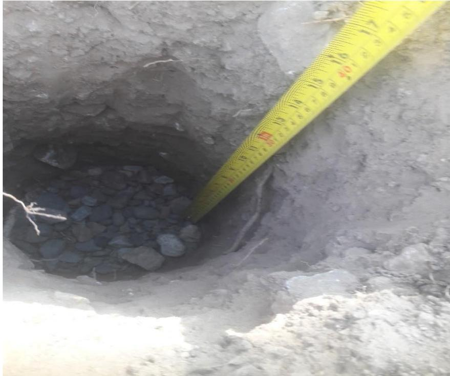
Fotografía 06: Se realizo el llenado de agua en el test de percolación para poder determinar la infiltración del terreno.
