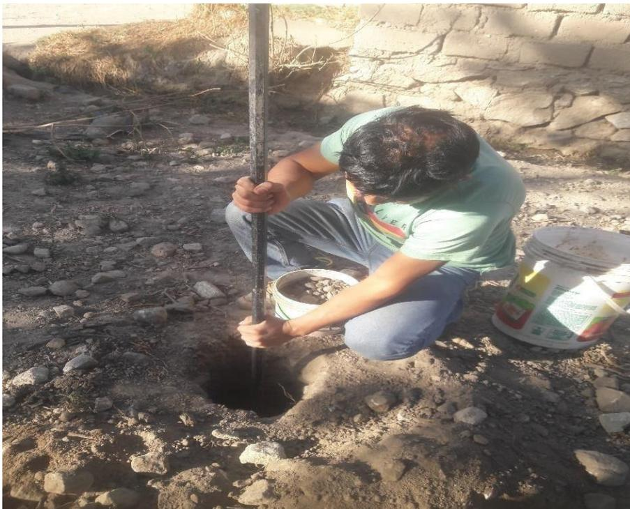
Fotografía 05: Se realizo la medición de 50 cm de altura para el test de percolación para poder determinar la infiltración del terreno.
