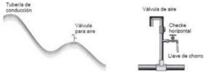
**Figura 9.** Válvula de aire
