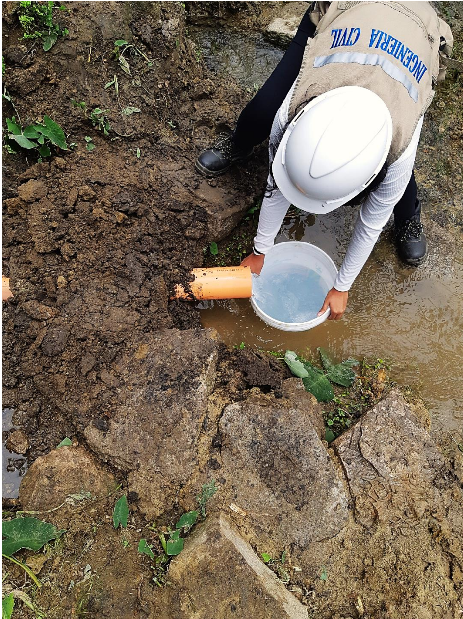
Figura 15: Aplicando el método volumétrico para hallar el caudal del manantial de ladera.
