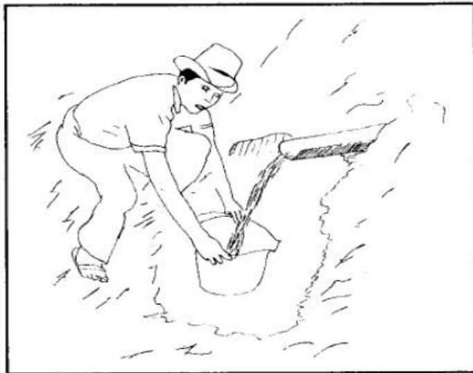
Figura 3. Aforo de agua por método volumétrico.
