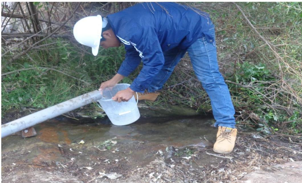
**Fotografía N° 01:** Aforo de la fuente Breña baja por el método Volumetrico.
