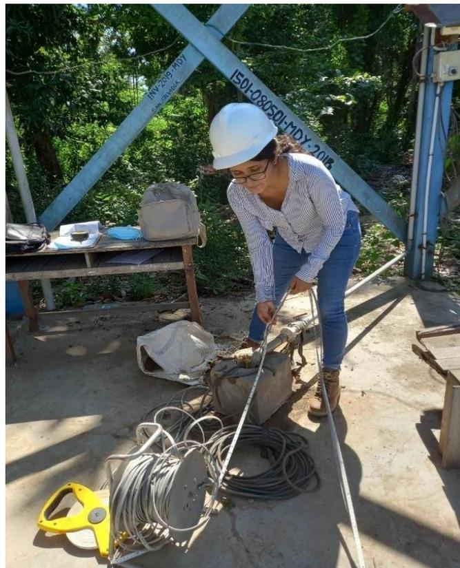
**Fotografía N°04:** Con el freatímetro se sacó la altura del agua en el pozo que tiene 80m de profundidad.
