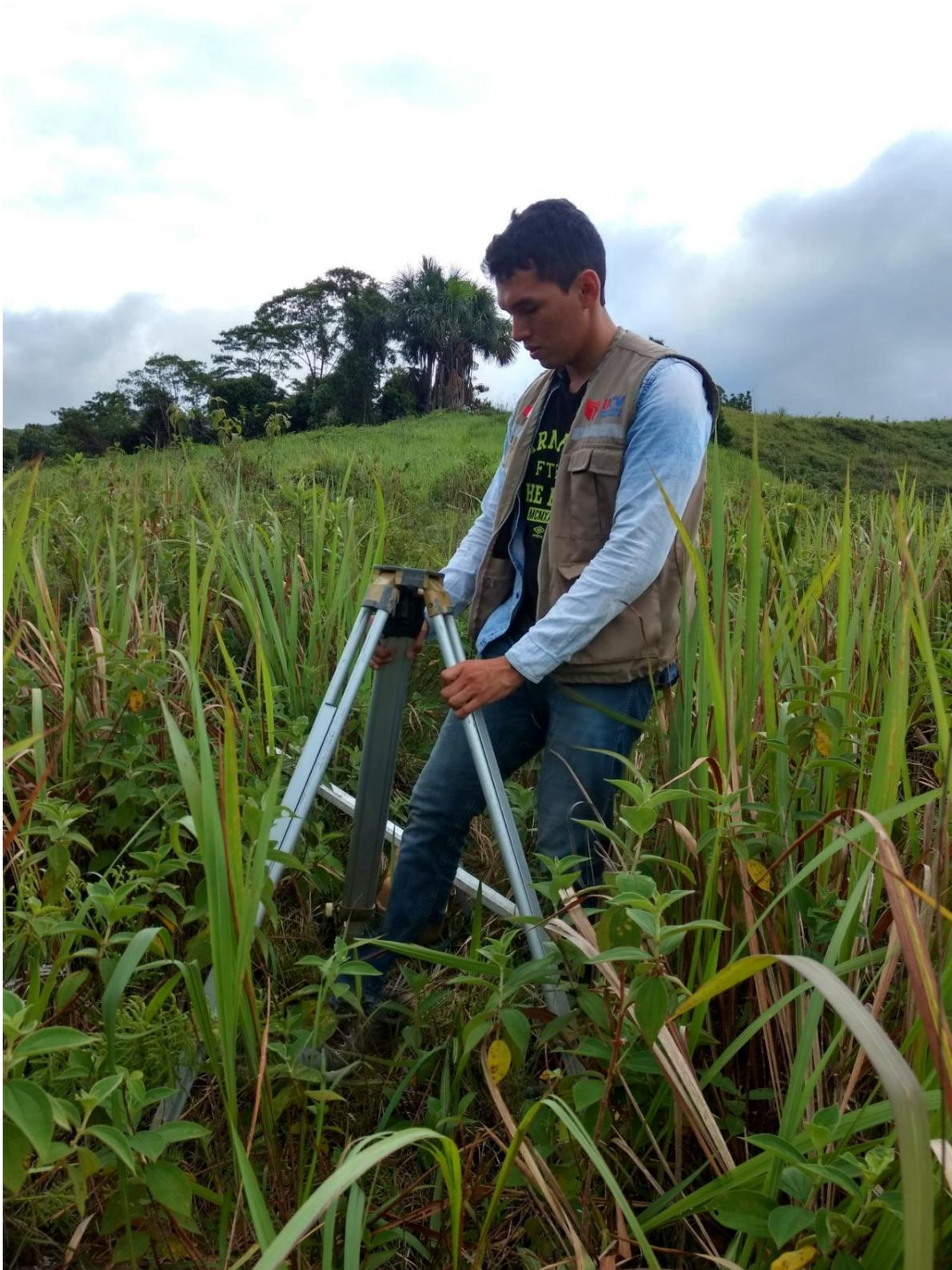
Estacionando el equipo topográfico
