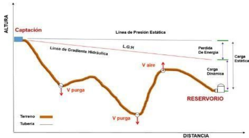
Ilustración N° 03.31. Línea de Conducción
