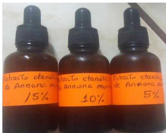
Se filtraron los macerados usando una bomba de vacío, con papel de filtro Whatman N° 1. Cada extracto etanólico se concentró en un rotavapor hasta obtener una masa siruposa. Esta se llevó a secar a la estufa a 40 °C. Al producto resultante se le denominó extracto seco. De estos, se prepararon las concentraciones de 5%(50mg/mL), 10%(100mg/mL) y 15%(150mg/mL)
