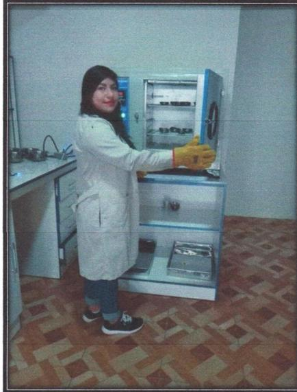
Fotografía N° 01: Secado en Horno Electrónico – Contenido de Humedad
