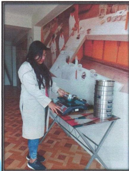
Fotografía N° 02: Pesado de muestra sacada del horno eléctrico
