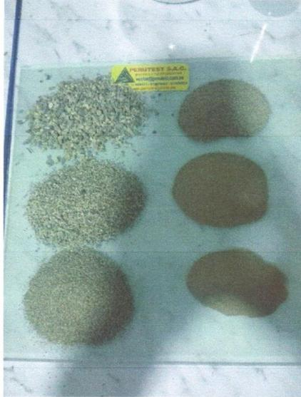
Fotografía N° 03: Tamizado de muestra para análisis granulométrico
