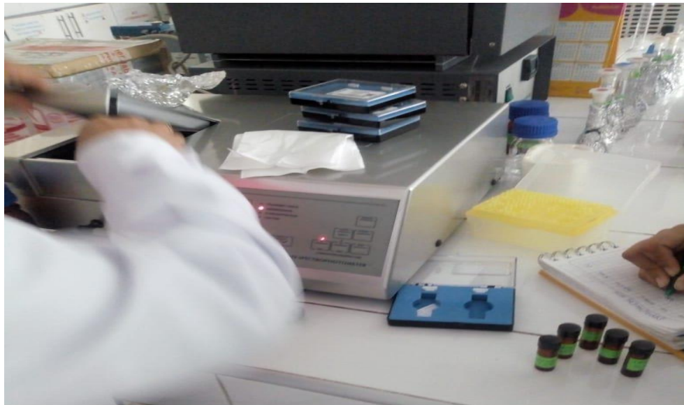
Figura 11. Lectura de las tres muestras del extracto metanólico de las hojas de Jatropha curcas L. “piñón blanco” en el espectrofotómetro ÚNICO 2800 UV/Vis.
