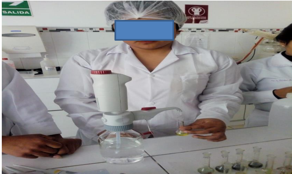
Figura 10. Colocación del \text{Na}_2\text{CO}_3 al 10% a las tres fiolas con las muestras problema del extracto metanólico de las hojas de Jatropha curcas L. “piñón blanco”.
