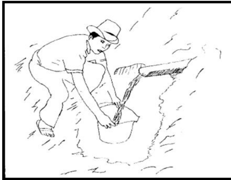
Figure 5 Aforo de agua por método volumétrico
