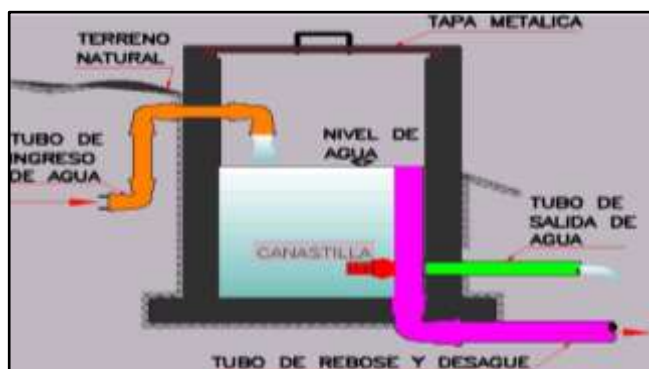
Figura 6: Cámara rompe presión tipo 6
