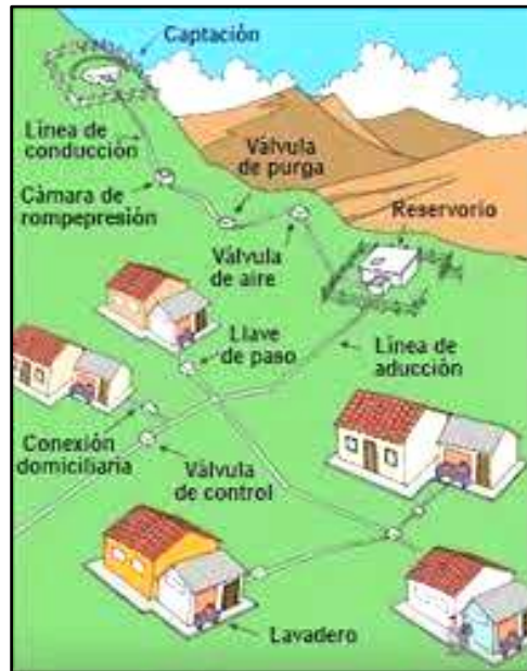
Figura 1: Sistema de abastecimiento de agua potable
