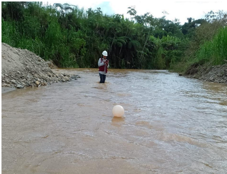
Método de Aforo con flotadores para conocer la velocidad
