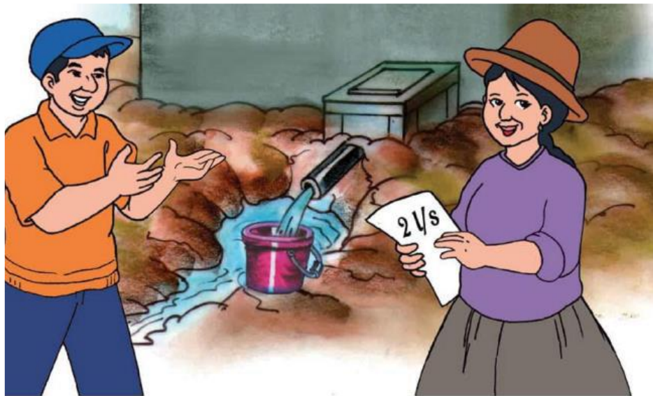
Imagen 3: Medición del caudal por el método volumétrico
