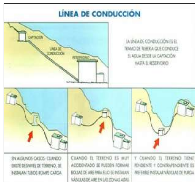
Figura 7. Línea de conducción
