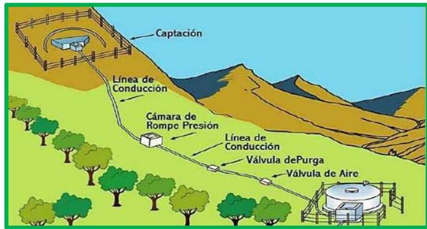
Figura 9: Línea de Conducción.
