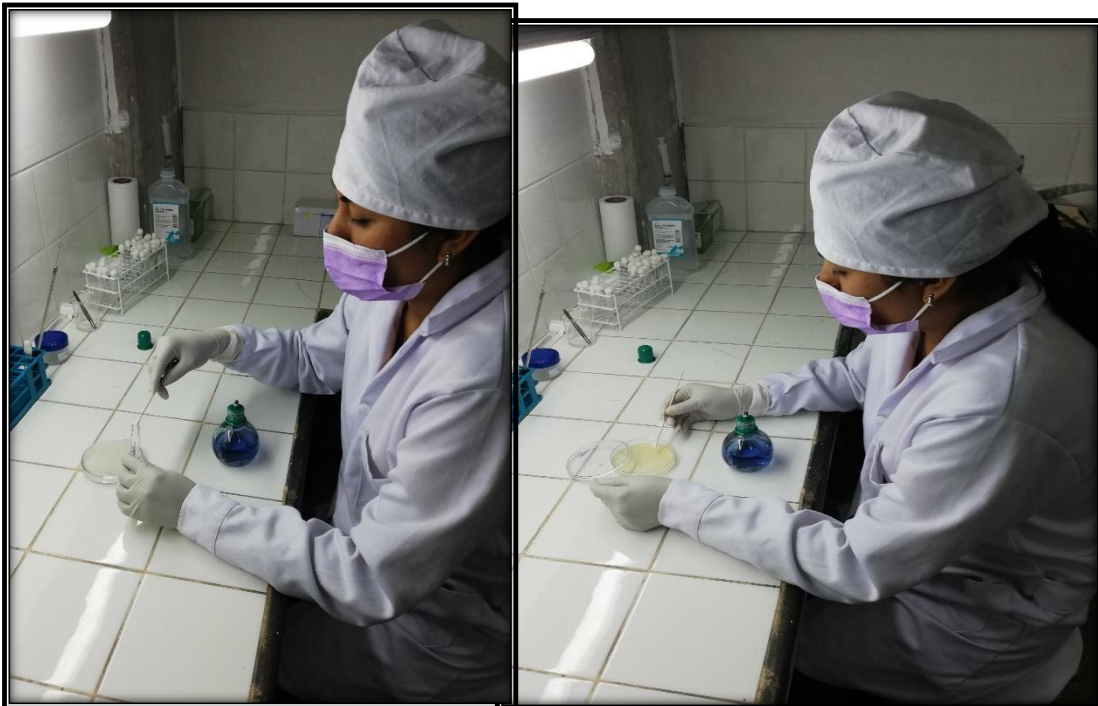
Figura 03. Inoculación de Streptococcus mutans ATCC 25175 en placas conteniendo Agar Miuller Hinton .
