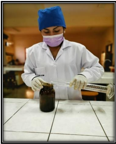
Figura 04. Se humectara con cantidad suficiente de 100 g de etanol al 70% y cada muestra humectada se llevara a un equipo de percolación y se añidira cantidad suficiente de 100 g de alcohol de 70% posteriormente se macera por un periodo de 24 h.
