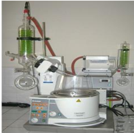
Concentración de los extractos en el rotavapor
