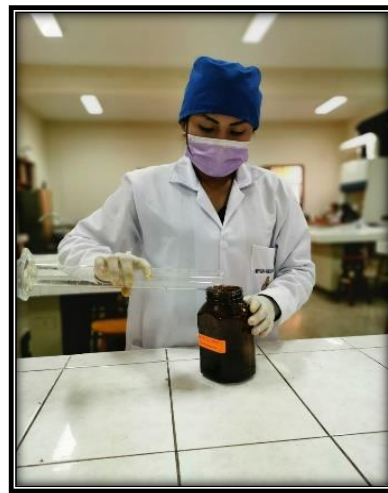
Figura 04. Se humectara con cantidad suficiente de 100 g de etanol al 70% y cada muestra humectada se llevara a un equipo de percolación y se añidira cantidad suficiente de 100 g de alcohol de 70% posteriormente se macera por un periodo de 24 h.
