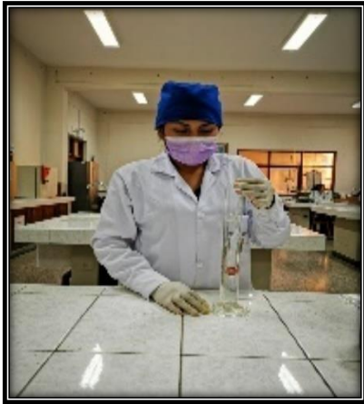
Figura 04. Se agrega alcohol de 70° en un tubo de ensayo y agua destilada y se mide con una pipeta para verificar la cantidad
