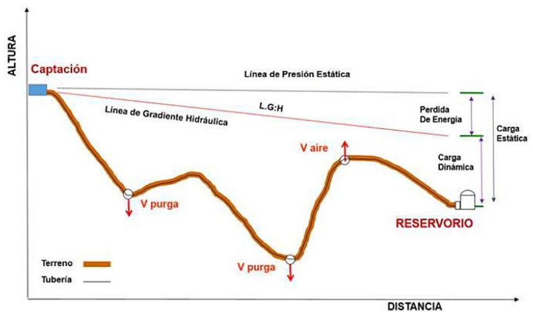
Ilustración N° 03.31. Línea de Conducción
