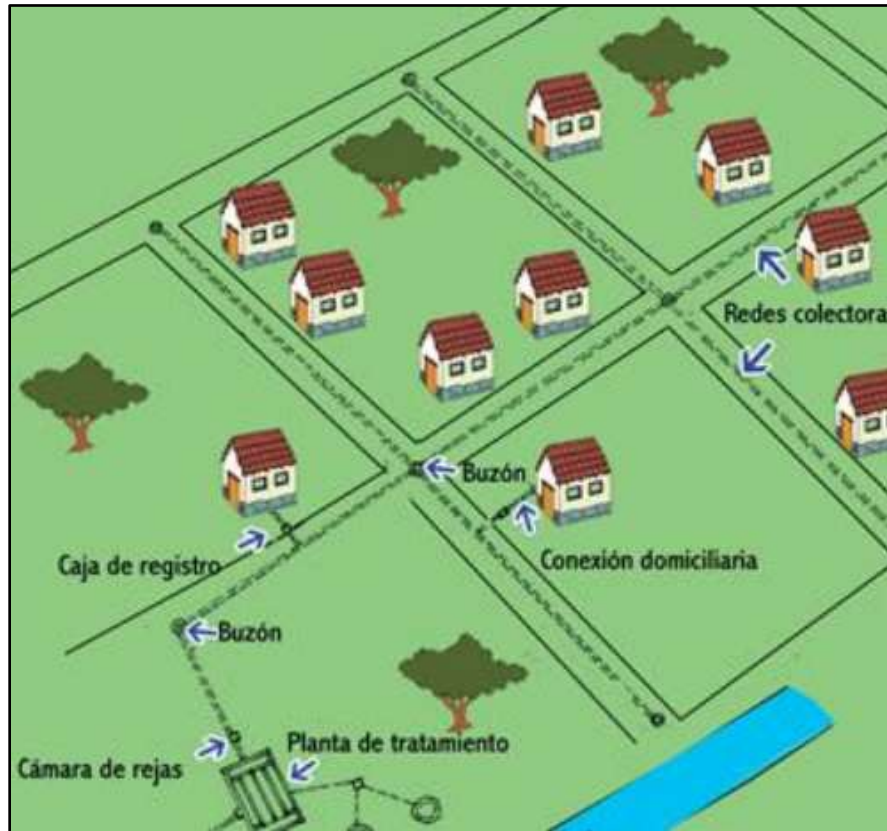
Figura 5. Esquema de un sistema de alcantarillado sanitario.
