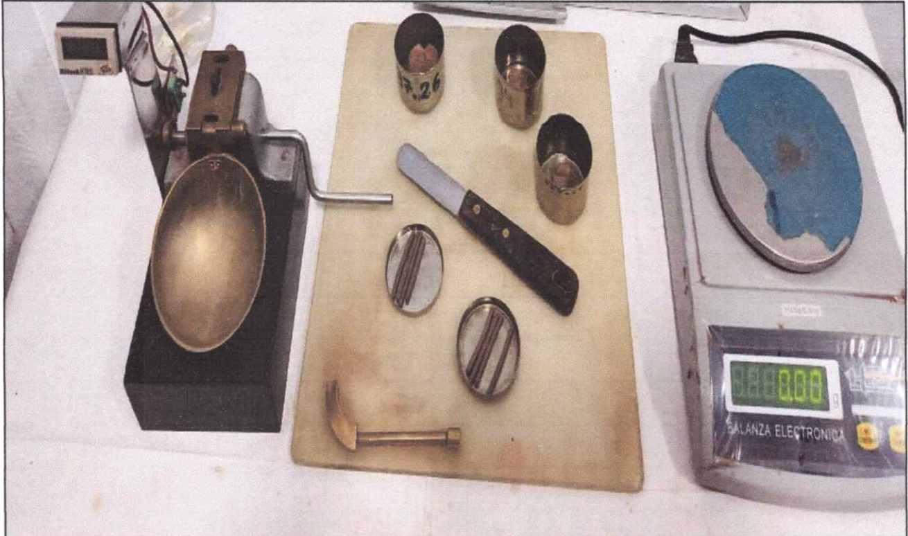
ENSAYO DE LIMITE LIQUIDO Y PLASTICO DE LA CALICATA 1 UBICADO EN EL RESERVORIO DEL SECTOR NUEVA BETANIA LADO EJE CENTRAL
