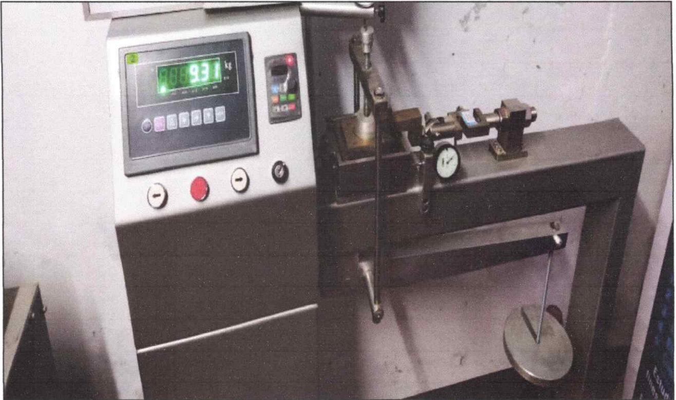
ENSAYO DE CORTE DIRECTO DE LA CALICATA 1 UBICADO EN EL RESERVORIO DEL SECTOR NUEVA BETANIA LADO EJE CENTRAL
