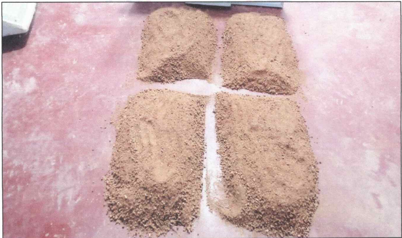
ENSAYO DE METODO DE CUARTEO DE LA CALICATA 1 UBICADO EN EL RESERVORIO DEL SECTOR NUEVA BETANIA LADO EJE CENTRAL
