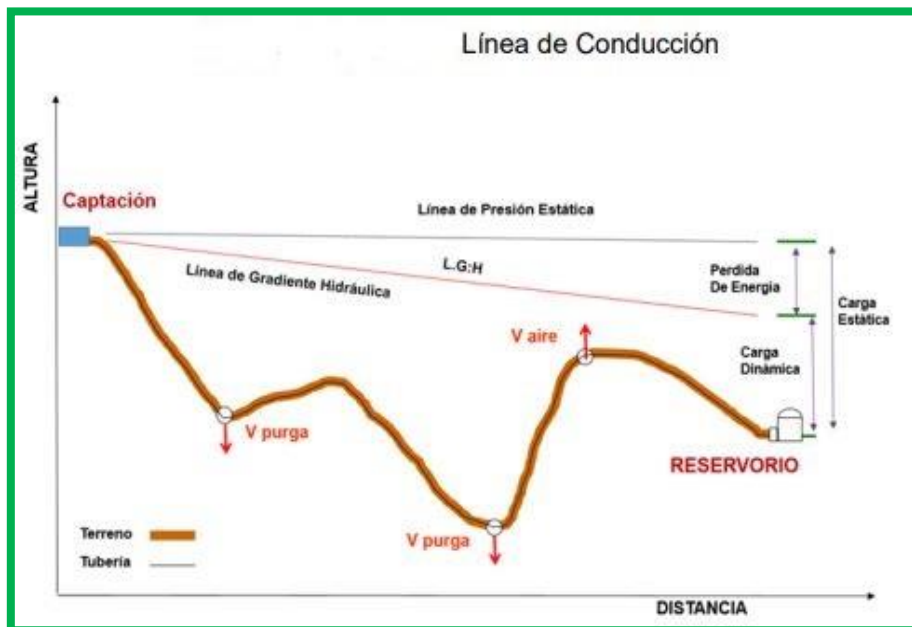
Figura N° 3 Línea de conducción
