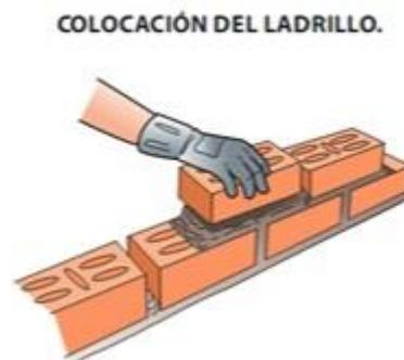
*Figura 3. Unión ladrillo con mortero.*
