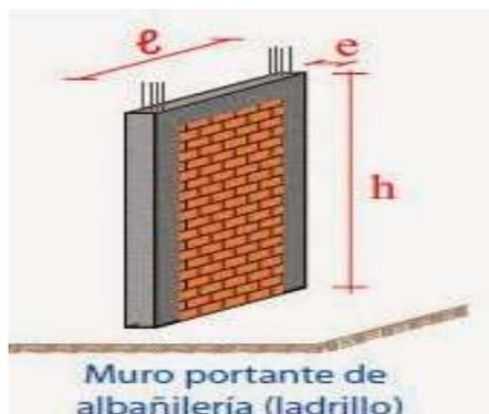
*Imagen 10. Muro portante de albañilería confinada*
