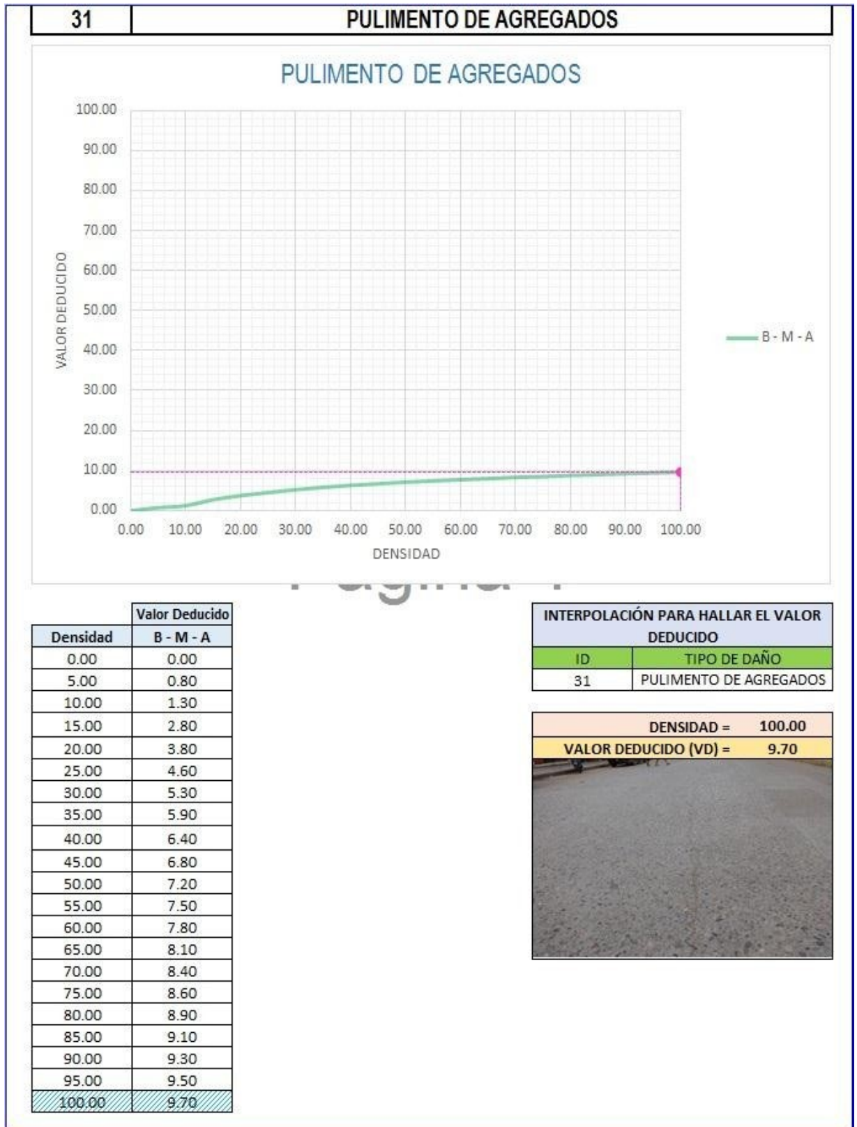
Figura 47. Patología de Pulimento de Agregados de La Unidad de Muestra 5.
