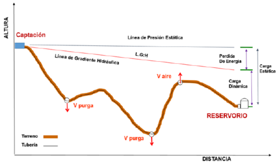
Ilustración N° 03.31. Línea de Conducción
