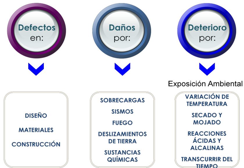
Figura 01: Clasificación general de patologías en edificaciones
