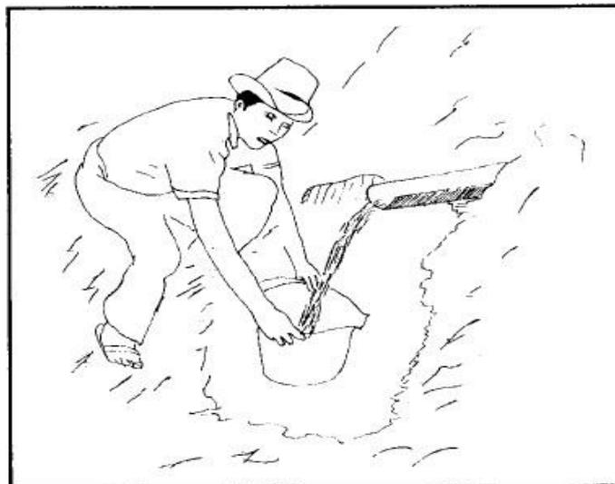
Figura . Aforo de agua por método volumétrico.
