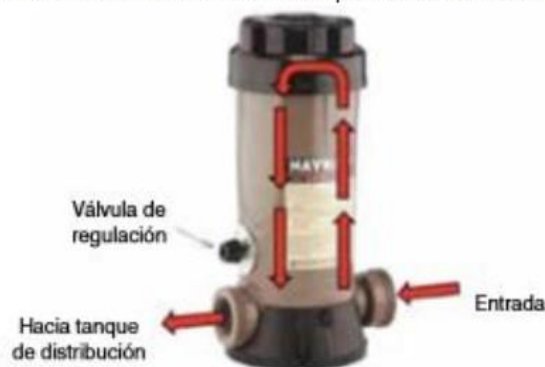
Ilustración N° 03.58. Dosificador por erosión de tableta
