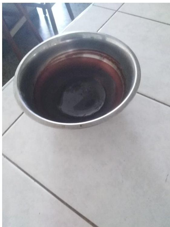
Evaporación de la preparación hidroetanólica de la semilla del cacao, luego se preparo las concentraciones 10%,25%,50% y 75%
