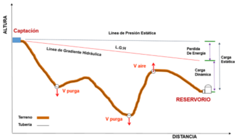
Ilustración N° 03.31. Línea de Conducción
