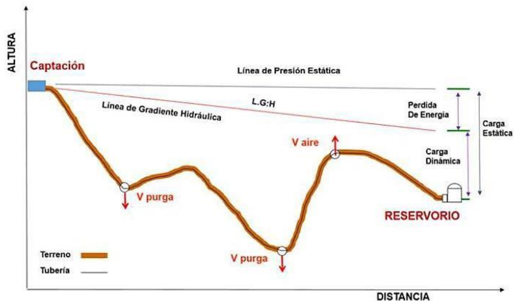
Ilustración N° 03.31. Línea de Conducción
