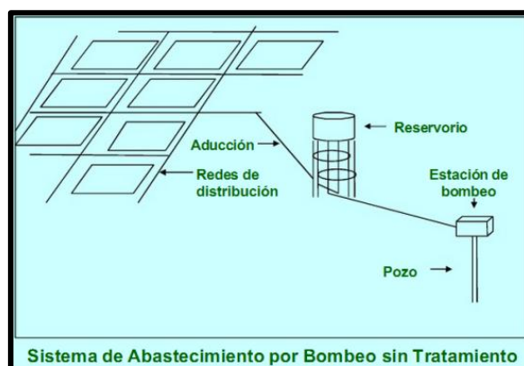
Figura 3: Sistema por bombeo.
