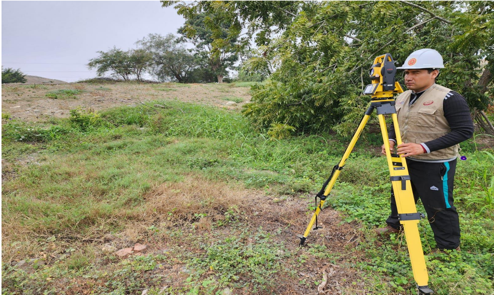
Imagen 3: Levantamiento topográfico con Estacion total en la Localidad de San Pedro.
