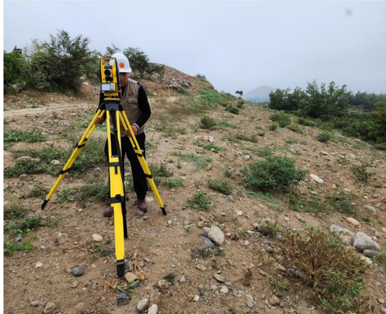
FOTO N° 07: VISTA GENERAL DEL EQUIPO TOPOGRAFICO EMPLEADO PARA EL LEVANTAMIENTO TOPOGRAFICO (ESTACION TOTAL MARCA SOUTH N40) Y EL TERRENO QUE PRESENTA LA LOCALIDAD DE SAN PEDRO EN EL DISTRITO DE HUALLANCA.
