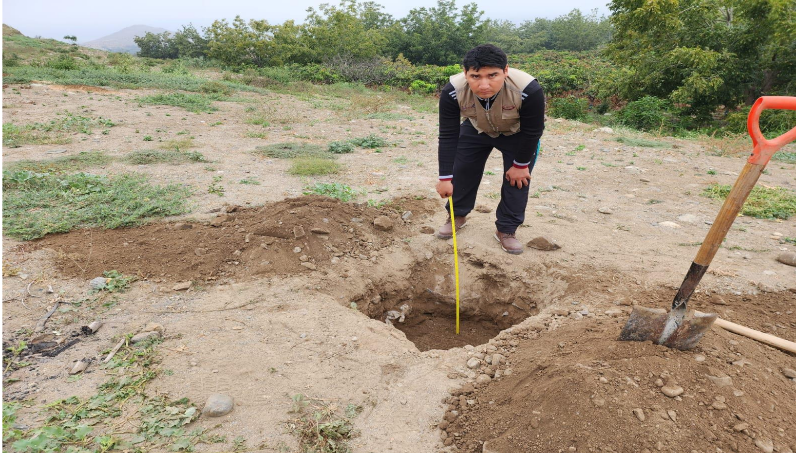
Imagen 2: Calicalata realizada para el Estudio de Mecánica de Suelos en la Localidad de San Pedro.
