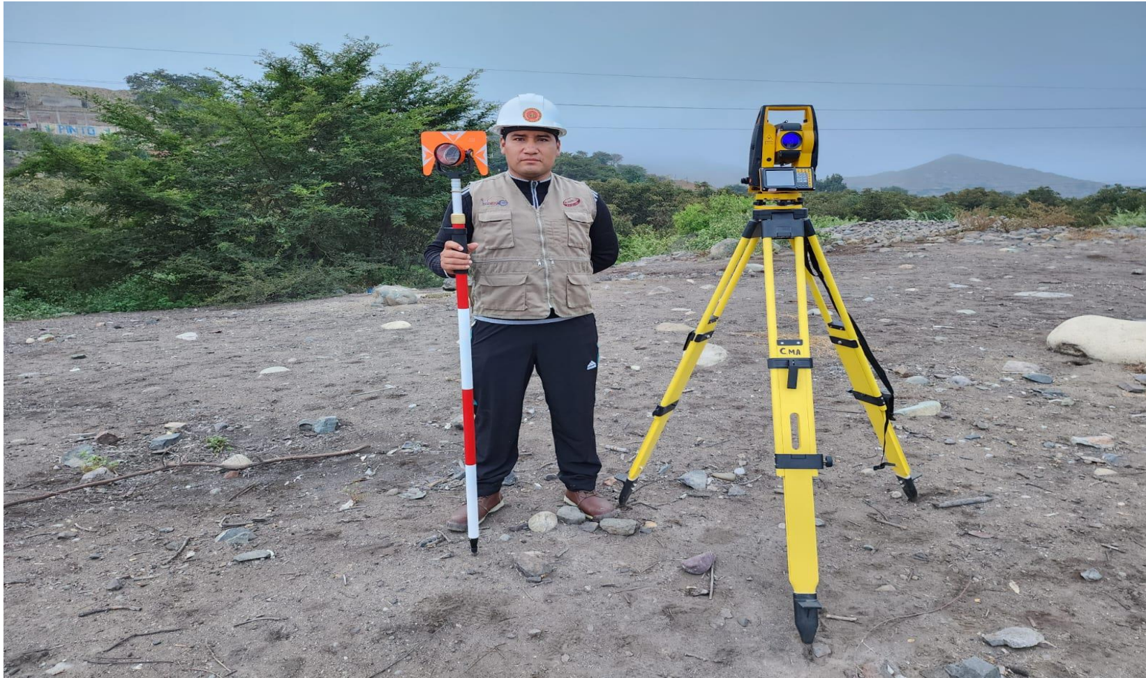
Imagen 4: Estacion total empleada para el levantamiento topografico en la localidad de San Pedro.
