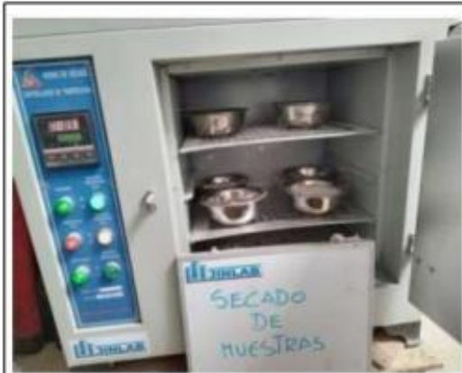
ENSAYOS DE CONTENIDO DE HUMEDAD
