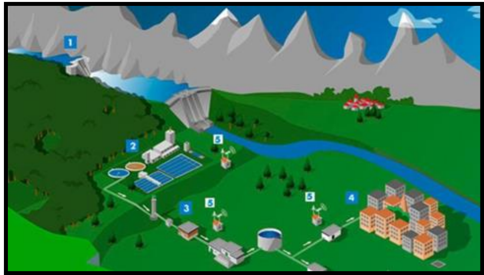
Figura N° 1 Sistema de abastecimiento de agua potable
