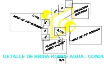
DETALLE DE BRIDA ROMPE AGUA - CONDUCCION
