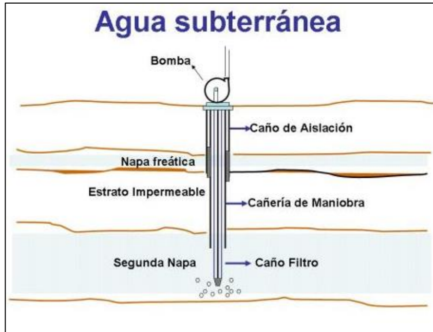
Figura 5. Captación de agua subterránea
