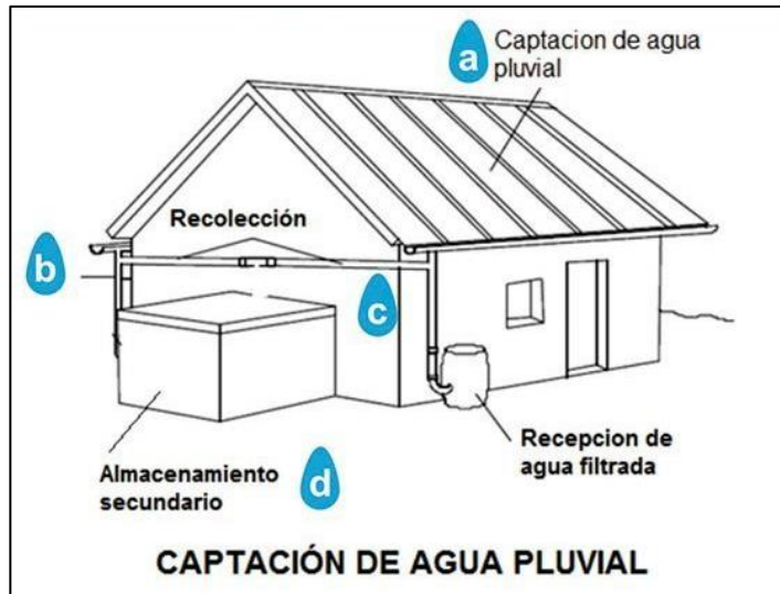
Figura 3. Captación de agua pluvial
