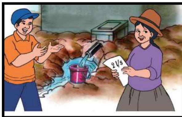
Figura 2: Método volumétrico
