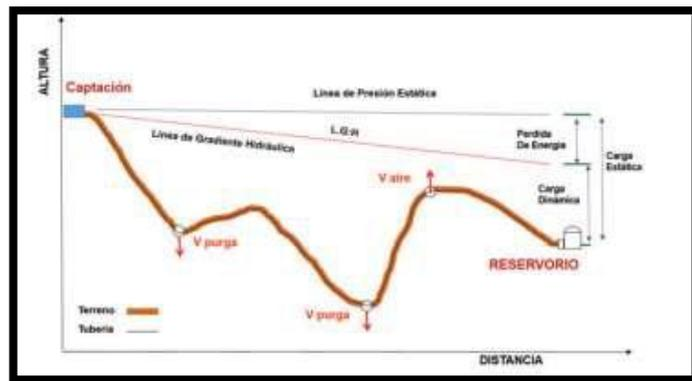
Figura 11: Línea de conducción
