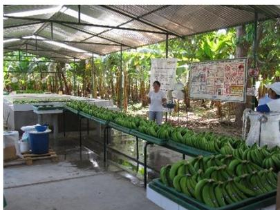
Terminada la colocación de stickers pasa al área de secado en la cual hay ventiladores que permiten un mejor secado del banano antes de su empaque; el secado dura aproximadamente unos 5 minutos.
